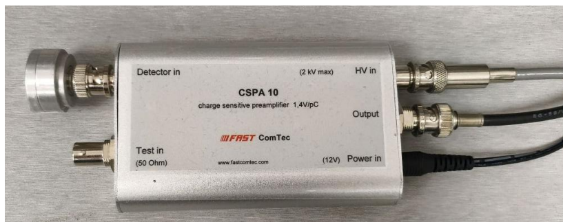
Obr. 5. Zapuzdrený detektor (vľavo) a jeho pripojenie k nábojovcitlivému predzosilňovaču cez BNC konektor.
