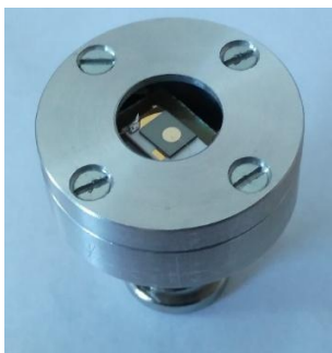
Obr. 5. Zapuzdrený detektor (vľavo) a jeho pripojenie k nábojovcitlivému predzosilňovaču cez BNC konektor.
