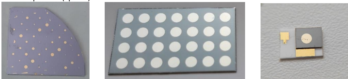
Obr. 2. Pripravené kruhové kontakty na GaAs substráte (vľavo), kontakty na SiC substráte (v strede) a samotný detektor pripravený na podložku vhodný na letovanie do krabičky, puzdra.
