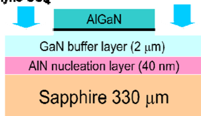
Obr.2 MESA – izolačné leptanie
